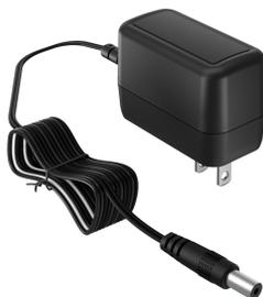
Источник питания для камеры. 120–240 В перем. тока, 50/60 Гц на входе; 12 В пост. тока, 1 А на выходе; регулируемый.
