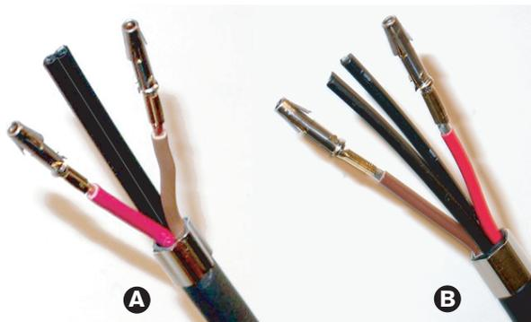
**Figura 6.79: Contactos de tomada instalados**
