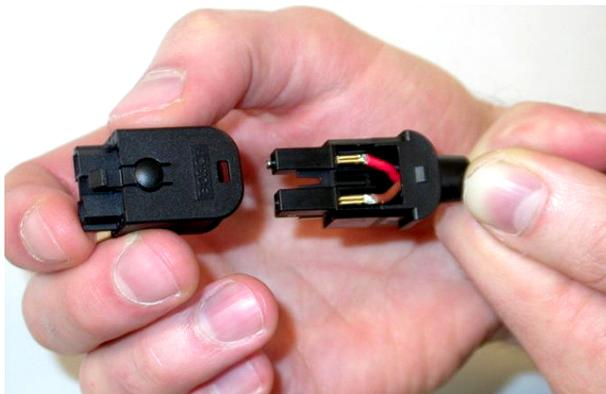
**Figura 6.99: Instalação do alojamento dianteiro**
