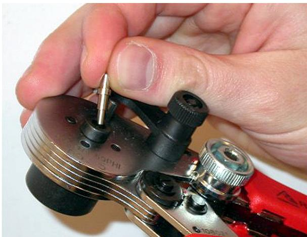
**Figura 6.85: Inserimento di una boccola**
