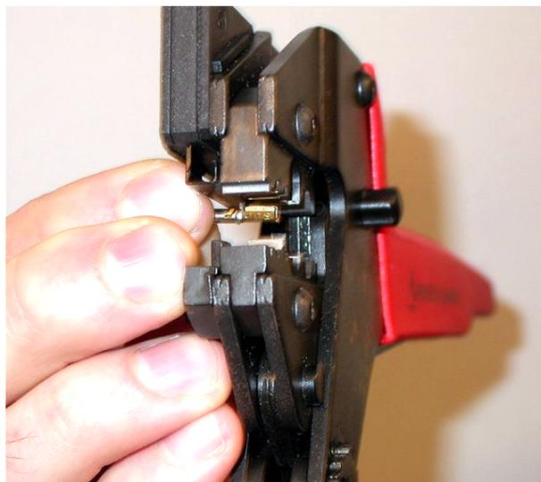
**Figura 6.76: Crimpatura di un contatto della presa (1)**
