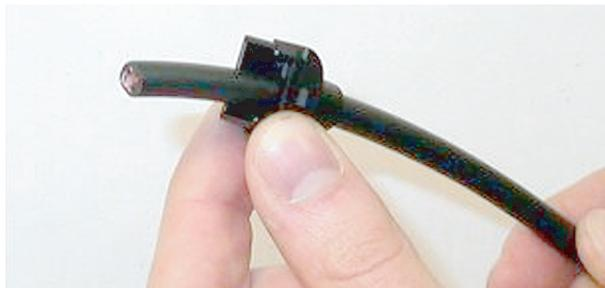
**Figura 6.70: Cavo inserito nell'involucro posteriore**
