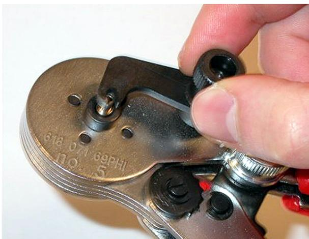
**Figura 6.86: Bloccaggio della boccola**
