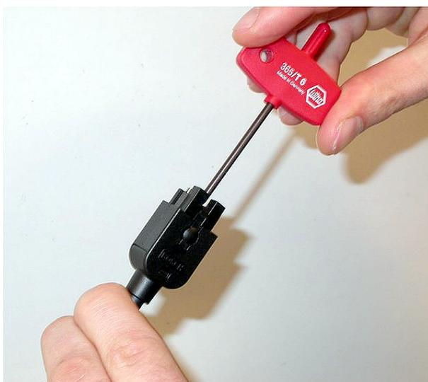
**Figure 6.101: Serrage de la vis Torx**
