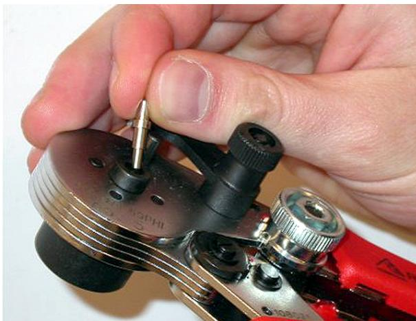
**Figure 6.85: Insertion d'une férule**
