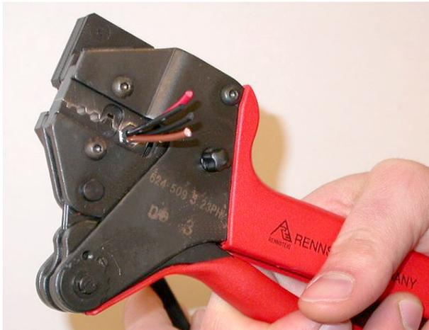
**Figure 6.73: Sertissage de la bague**
