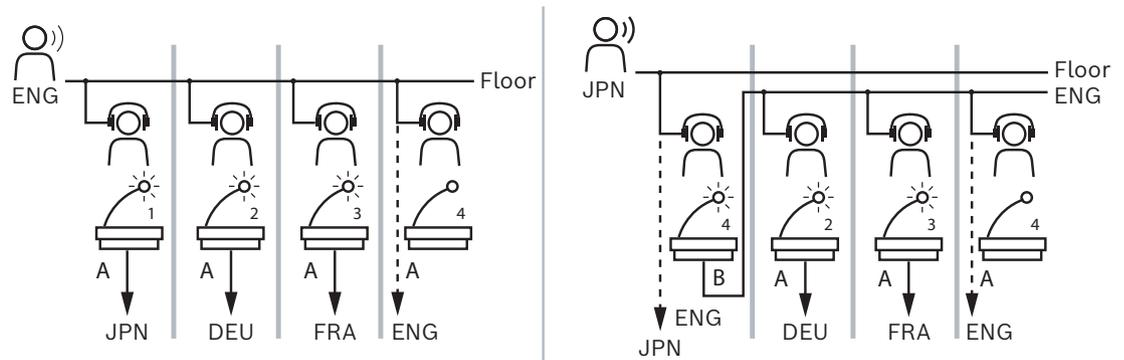
**Figura 5.7:** Interpretação normal e do relé automático
