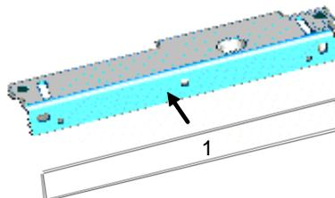
2. Fügen Sie den Befestigungsbügel des Bausatzes (A) und den Metallbügel des Sperrlements (B) wie unten angegeben zusammen. Fixieren Sie die Messingblöcke (C) mit den Schrauben (2), ohne jedoch die Schrauben ganz festzuziehen.
