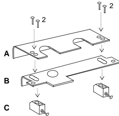
3. Klemmen Sie das Glas in den Zwischenraum von (A) und (B) und ziehen Sie die Schrauben (2) fest, wenn Sie die endgültige Montageposition gefunden haben
