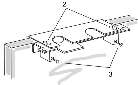
5. Gehen Sie für die weitere Montage von Sperrlement, Magnetkontakt und Abdeckungen nach den Ausführungen im Montagehinweis zum Auf-Tür-Bausatz vor.
