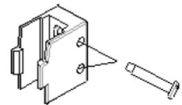
Leitungsschleife mit Kunststoffhalter oder als Alternative Montageteil am Riegelaschenboden (siehe Abbildung 5).
