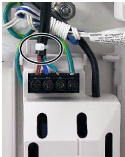
Illustrasjon 2.3 Kabelstropp for hovedkabler til strømforsyning
