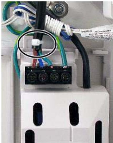
**Figura 2.3** Sujetacables de la RED ELÉCTRICA a la fuente de alimentación
