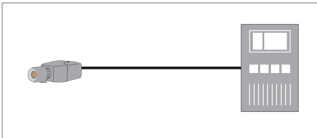
AVIOTEC IP starlight 8000 можно подключить к панели управления пожарной тревоги. Сигнал тревоги будет активироваться выходом реле камеры.
