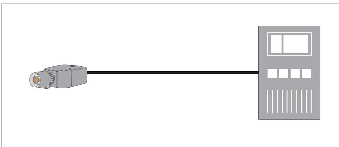
O AVIOTEC IP starlight 8000 pode ser ligado a um painel de controlo de alarme de incêndio. O alarme será acionado pela saída de relé da câmara.
