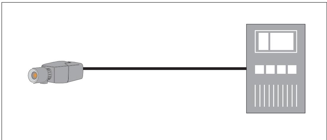
Le système AVIOTEC IP starlight 8000 peut être connecté à la centrale de commande de l'alarme incendie. L'alarme est déclenchée par la sortie de relais de la caméra.
