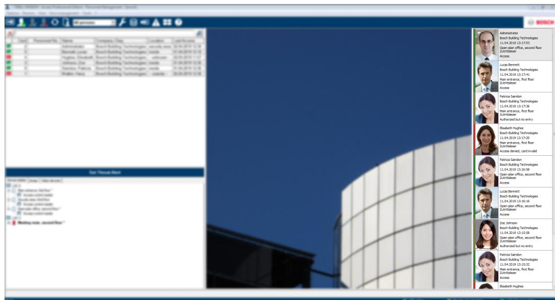
В области онлайн-считывания отображаются не более 400 событий за последние 48 часов для выбранных проходов. События отображаются в режиме реального времени.
