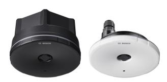
Der PRA-ANS ist ein Umgebungsgeräusch-Sensor zur Überwachung von sich ändernden Umgebungsgeräuschpegeln zur automatischen Anpassung von Durchsage- oder Hintergrundmusikpegeln (AVC – Automatic Volume Control). Dadurch wird sichergestellt, dass das Audiosignal des Beschallungssystems auf einem konfigurierbaren Pegel über dem Umgebungsgeräusch angepasst wird um Durchsagen verständlich zu machen, die Lautstärke jedoch angenehm zu halten.
