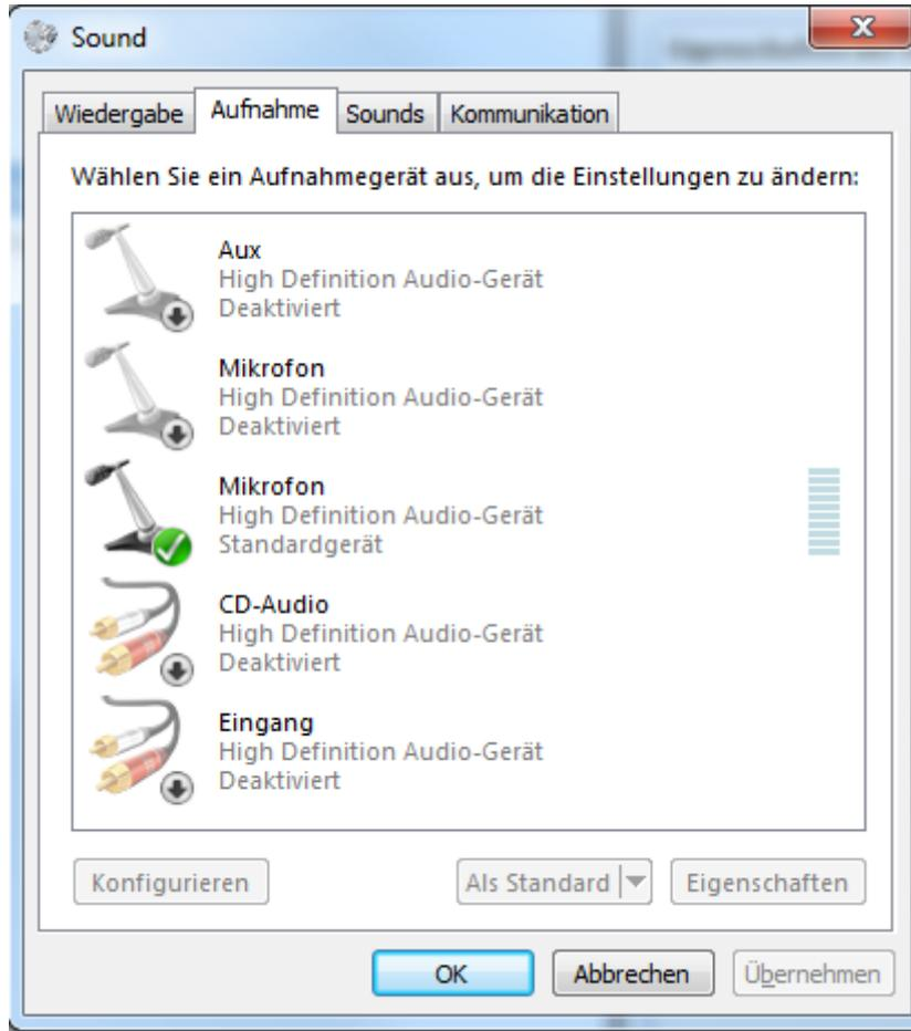
Si vous basculez de mélange stéréo à microphone, après le premier démarrage de Operator Client, ce réglage sera ignoré au démarrage suivant de Operator Client. Pour éviter les effets Larsen, il est conseillé d'utiliser un microcasque plutôt qu'une association microphone/haut-parleur.
