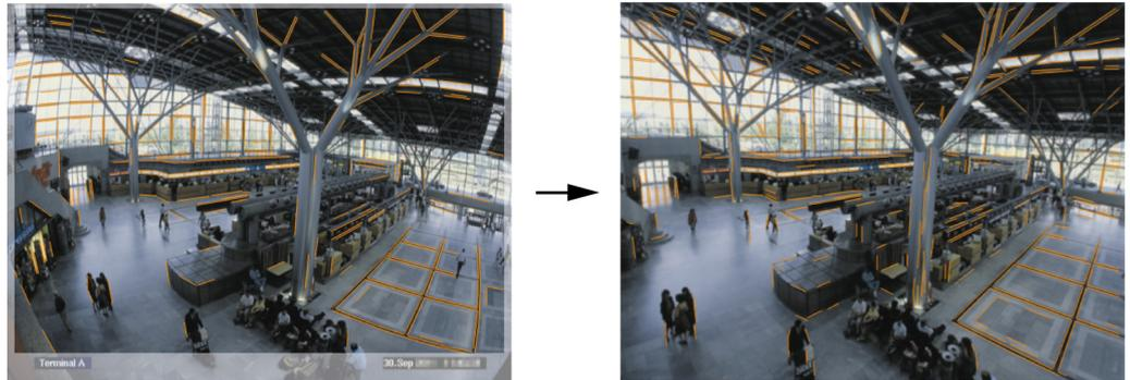
**Abbildung:** Auf dem Bild rechts sind die Kanten gerade. Die Deckenleuchten und die Markierungslinien auf dem Boden sind nicht verzerrt.
