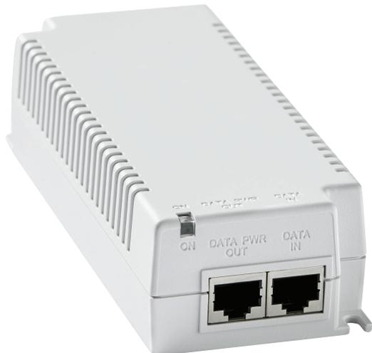
O midspan via PoE ativa a energia de PoE remoto para câmeras IP PTZ compatíveis da Bosch. O midspan via PoE gera um máximo de 60 W e está em conformidade com o padrão IEEE 802.3bt. O midspan PoE tem uma única porta e fornece energia em todos os quatro pares.
