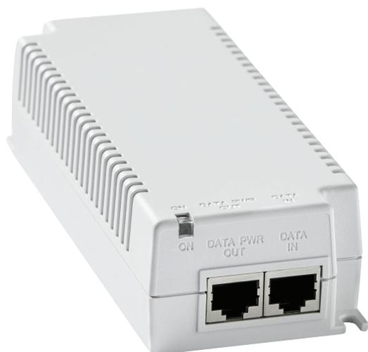
Il midspan PoE consente l'alimentazione PoE da remoto per telecamere PTZ IP compatibili di Bosch. Il midspan PoE genera un massimo di 60 W ed è conforme allo standard IEEE 802.3bt. Il Midspan PoE ha una porta singola e fornisce l'alimentazione a tutte e 4 le coppie.
