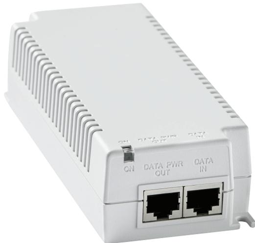
L'injecteur PoE permet l'alimentation PoE à distance des caméras mobiles IP compatibles Bosch. L'injecteur PoE génère une puissance maximale de 60 W et est conforme à la norme IEEE 802.3bt. L'injecteur PoE a un seul port et fournit une alimentation sur les 4 paires.
