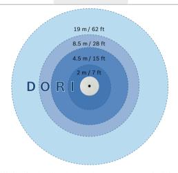
当安装在3米(10英尺)高的位置时,180°型摄像机在这四个级别下分别具有如下覆盖半径:
