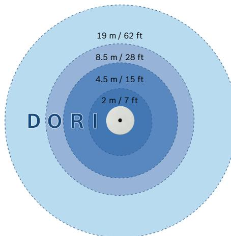
При установке на высоте 3 м версия камеры с объективом 180° имеет следующий радиус покрытия на четырех уровнях:
