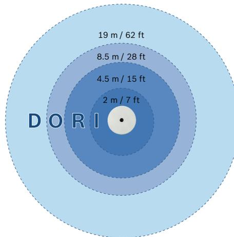
Se montata all'altezza di 3 m, la versione 180° della telecamera fornisce il seguente raggio di copertura per i quattro livelli:
