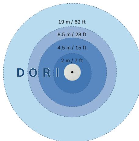
Lorsqu'elle est installée à une hauteur de 3 m, la version 180° de la caméra a le rayon de couverture suivant pour les quatre niveaux :
