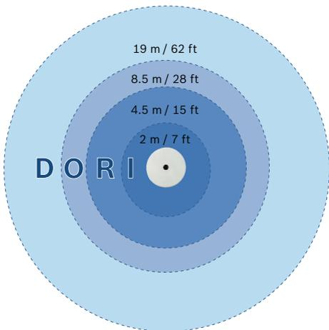
Cuando se monta a una altura de 3 m (10 pies), la versión de 180° de la cámara dispone de los siguientes radios de cobertura para los cuatro niveles:
