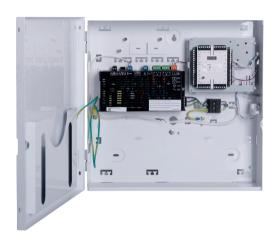
NEV 400 LSN обеспечивает дистанционную подачу питания и устанавливается вне панели управления. Информация о неисправностях и несанкционированных вскрытиях передается по LSN (локальная сеть безопасности). Опционально может быть добавлено до трех конвертеров 12 В и одна плата защиты SIV 28.
