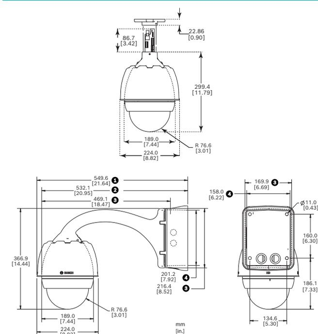
Fig. 1: Dimensões, suporte para tubulação AUTODOME7000, suporte suspenso
