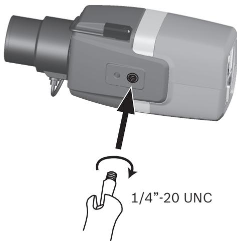
Die Kamera kann von oben oder von unten montiert werden
