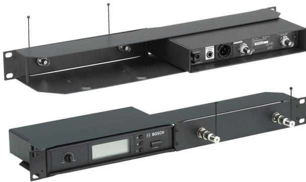
Kit ini adalah untuk pemasangan MW1-RX-Fx Wireless Microphone Receivers di rak 19". Kit ini bisa memasang dua unit, berdampingan dalam ruang rak tinggi satu unit. Ketika hanya digunakan satu unit, separuh frame lainnya bisa dipasangkan dengan panel yang telah disediakan, yang bisa memasang dua antena. Ini disambungkan ke penerima melalui dua kabel BNC yang disertakan.
