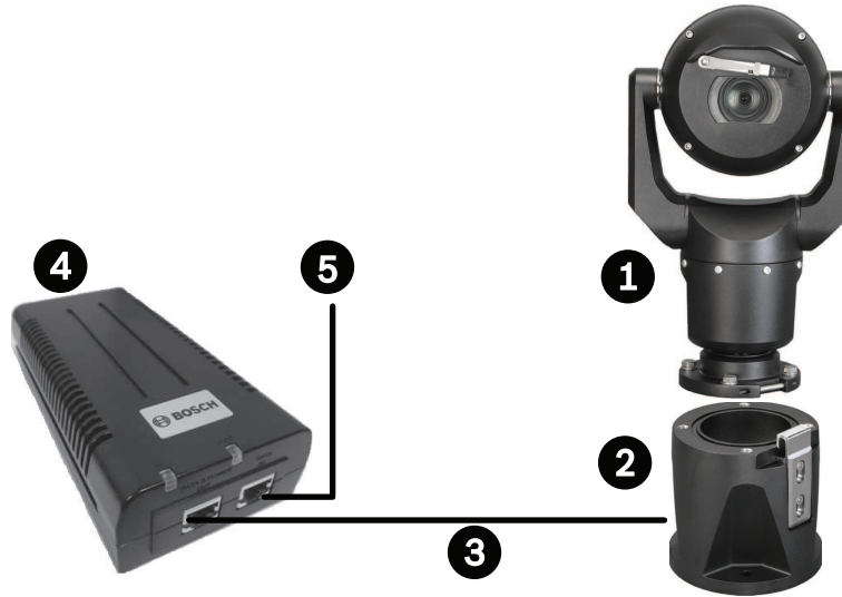
Figure 9.1: Configuration IP standard avec Injecteur PoE haute puissance (pas de connexion E/S)
