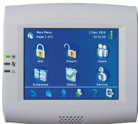
Questa tastiera di comando di semplice utilizzo è un dispositivo di input per la soluzione MAP 5000. Ciascuna tastiera di comando è dotata di schermo LCD da 14 cm. Il resistente touch screen fornisce agli utenti l'accesso alle funzioni del sistema attraverso un'interfaccia coinvolgente con icone intuitive. L'utente tocca direttamente le immagini sullo schermo per inserire, disinserire o selezionare le opzioni di menu. Il testo è mostrato nella lingua associata al login di accesso dell'utente.
