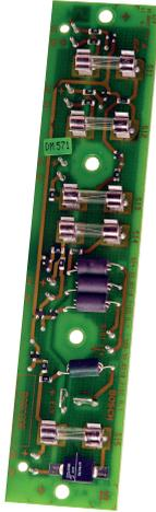
Zur überwachten Absicherung von z. B. an die MAP5000 angeschlossenen Verbrauchern, max. 5 Sicherungen.
