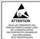
NOTE: Il est impératif de porter un bracelet de mise à la terre et de prendre les précautions d'usage lors de la manipulation des circuits imprimés sensibles aux décharges électrostatiques.
