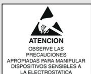
NOTA: Deben llevarse muñequeras y respetarse las precauciones de seguridad ESD adecuadas durante el manejo de las placas de circuitos impresos sensibles a la electrostática.
