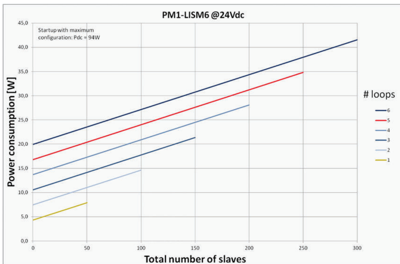
Obrázek 11.1: Odběr z akumulátoru při 24 V DC
