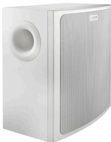
El LB6-SW100-L consta de un módulo subwoofer de 8 pulgadas de alto rendimiento con una red cruzada para alimentar hasta cuatro (4) altavoces satélite compactos LC6-S-L de 2 pulgadas. El LB6-SW100-L puede admitir conexiones de señal de 4/8 ohmios o de 70/100 V. Por su gestión de alta potencia, el subwoofer se puede utilizar en distintos entornos y espacios para mejorar la música de alta calidad de fondo o en primer plano.
