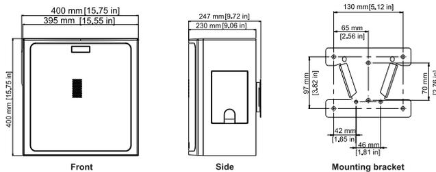
*Caisson de sub-grave pour montage en surface et support de montage*
