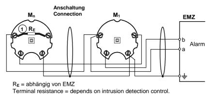
(1) Anschlussdrähte mit Isolierschlauch überziehen.
