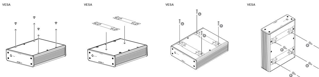
解码器附带4个支架。请将装置放在合适的平坦表面上，确保其不会掉落。
