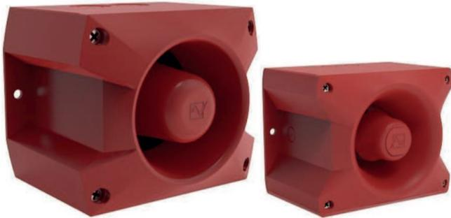
Промышленные звуковые оповещатели PA 5 и PA 10-SSM представляют собой акустические устройства универсального назначения для применения в системах пожарной и охранной сигнализации. Они имеют степень защиты IP 66, работают от 24 В пост. тока и соответствуют стандарту EN 54-3.
