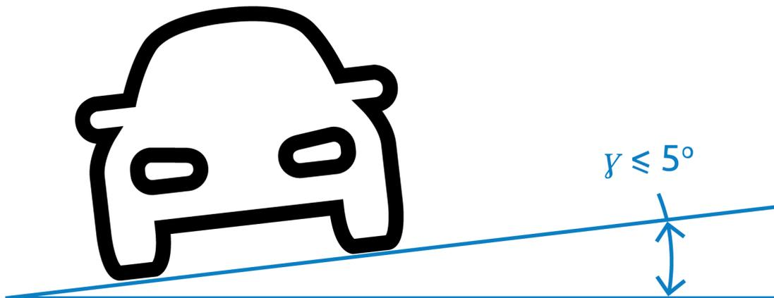
為了獲得極佳性能，傾斜角度應在  $-5^\circ \leq \gamma \leq +5^\circ$  範圍內，但必須在  $-30^\circ \leq \gamma \leq +30^\circ$  範圍內。
