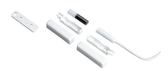
Der LSN-Aufbaumagnetkontakt dient zur Öffnungsüberwachung von Türen und Fenstern. Der Kontakt hat eine Sabotageüberwachung. Wenn sich ein externer Magneten nähert, wird der Gerätekontakt aktiviert und verursacht einen Protokolleintrag.
