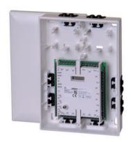
Es können maximal 2 IMS-RM Relaismodule im ISP-EMIL-120-Koppler und im ISP-EMIL-3RDP-Koppler installiert werden, wenn der hohe Energiebedarf der angeschlossene Kontrollelemente dazu führt, dass diese nicht mehr direkt vom Koppler angesteuert werden können, oder um potenzialfreie Kontakte bereitzustellen. IMS-RM-Relaismodul mit 2 Relais, 2 Umschaltekontakte je Relais für potenzialfreie Kontakte.
