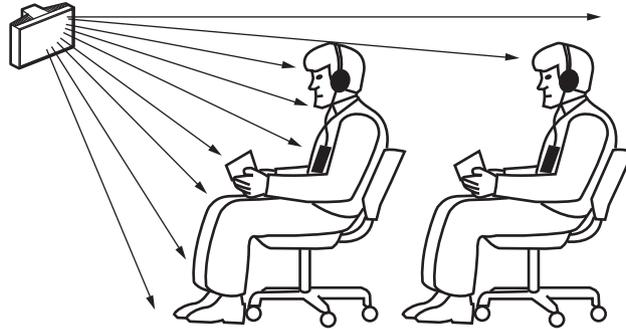
**Figure 4.9:** Signal infrarouge bloqué par la personne se trouvant devant le participant
