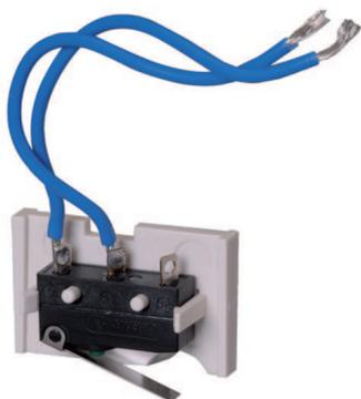
Il contatto anti-manomissione da parete IMS-WTC viene installato nella parte inferiore dell'alloggiamento del modulo di espansione ISP-EMIL-120 LSN. In caso di rimozione dell'alloggiamento dalla parete, viene trasmesso un allarme anti-manomissione.
