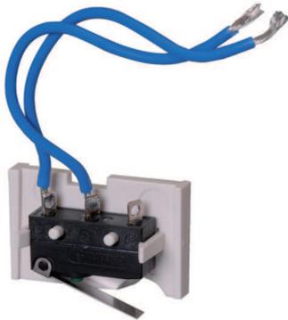
Der IMS WTC Abreißmelderkontakt wird im unteren Teil des Gehäuses des ISP-EMIL-120 LSN-Kopplers installiert. Wenn das Gehäuse aus der Wand gebrochen wird, wird ein Sabotagealarm übermittelt.
