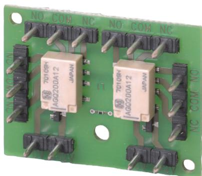
Modulo relè IMS-RM con 2 relè, 2 contatti di commutazione per relè per uscite a potenziale zero. Il modulo relè IMS-RM può essere installato se gli elevati requisiti di alimentazione degli elementi di controllo collegati rendono impossibile l'attuazione diretta dal modulo di espansione ISP-EMIL-120 LSN o se si desidera attivare la commutazione a potenziale zero.
