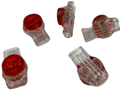
3-adrige Kabelverbinder, die zum Anschluss von Kabeln mit einem Durchmesser von 0,4 – 0,9 mm (AWG 19 – 26) verwendet werden. Eine zusätzliche Isolierung ist nicht erforderlich.
