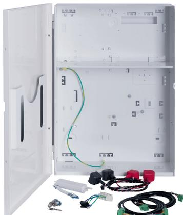
El kit de caja de alimentación MAP (ICP-MAP0115) contiene una caja de alimentación MAP, un interruptor de bucle antisabotaje para el panel MAP, un juego de cerradura para la caja MAP, un bloque de terminales MAP CA y un paquete de accesorios con cables de conexión. La caja de alimentación MAP está diseñada para albergar hasta dos conjuntos de baterías 2x 12 V/38-45 Ah.
