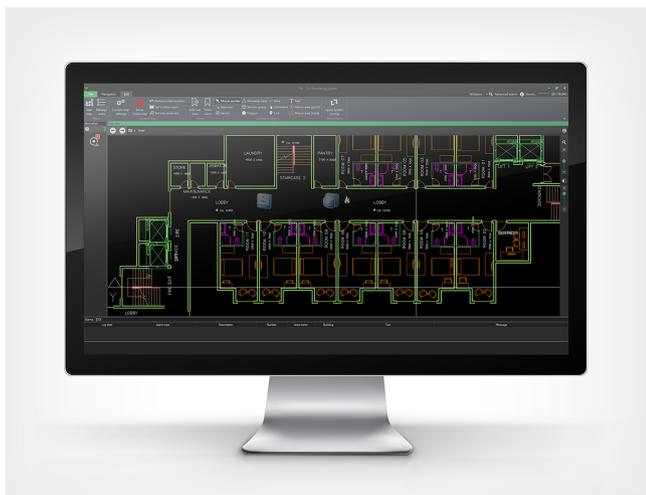
O Sistema de monitoramento de incêndios é uma interface gráfica com o usuário para apresentação e monitoração de pequenos e médios sistemas de alarme de incêndio com até 10000 pontos de detecção. É compatível com AVENAR panel 8000, AVENAR panel 2000, FPA-5000 e FPA-1200.
