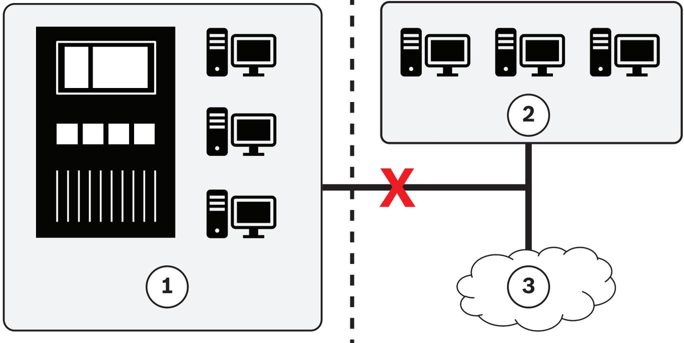
Un réseau Ethernet exclusif pour la configuration d'un réseau d'alarme incendie central (1) est requis. Pour des raisons de sécurité et de fiabilité, aucun réseau utilisé à d'autres fins (2) ne peut faire
